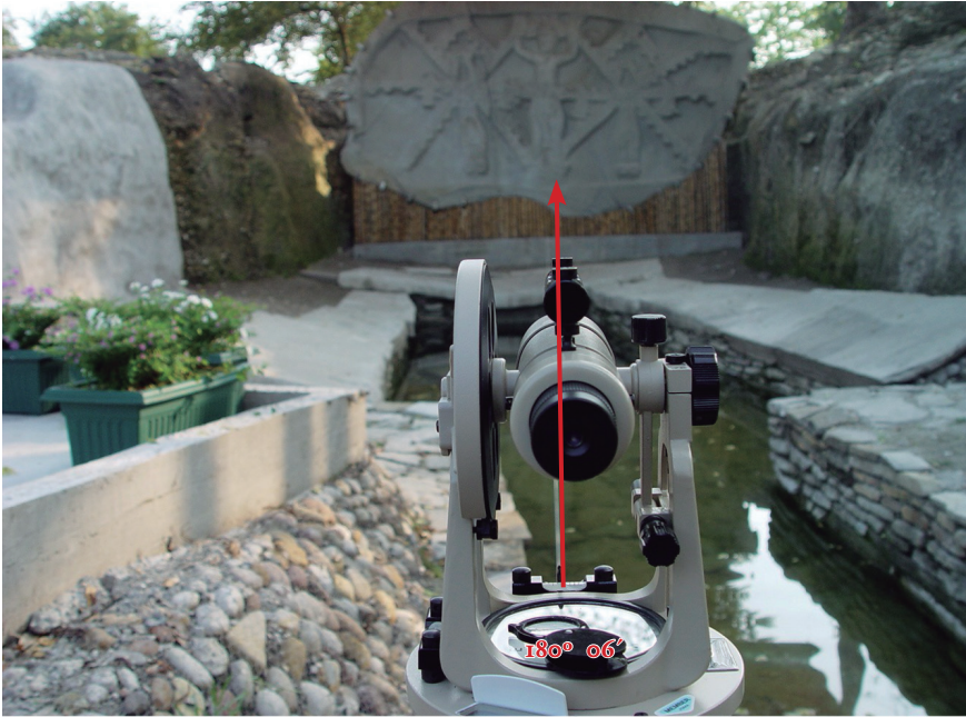
5. La medición de la orientación de M32 respecto al cielo con la ayuda de un tránsito topográfico colocado perpendicularmente al monolito, orientado casi hacia el norte astronómico. Foto del autor. SECULT.-INAH.-MÉX “Reproducción autorizada por el Instituto Nacional de Antropología e Historia”.
