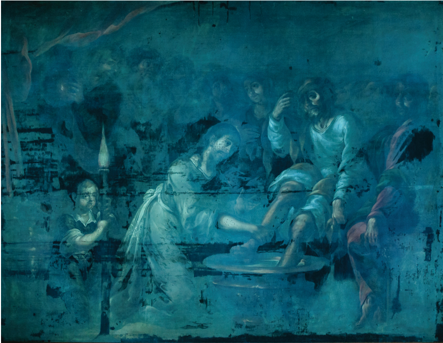
10. Cristóbal de Villalpando, El Lavatorio , estudio bajo luz ultravioleta, el cual permite observar la línea de la costura debido a la alta absorción de los materiales usados en los resanes y repintes de restauraciones previas. Para inducir el fenómeno de fluorescencia se emplearon lámparas uvp Handheld en onda corta (258 nm). Foto: Eumelia Hernández, 2019.
