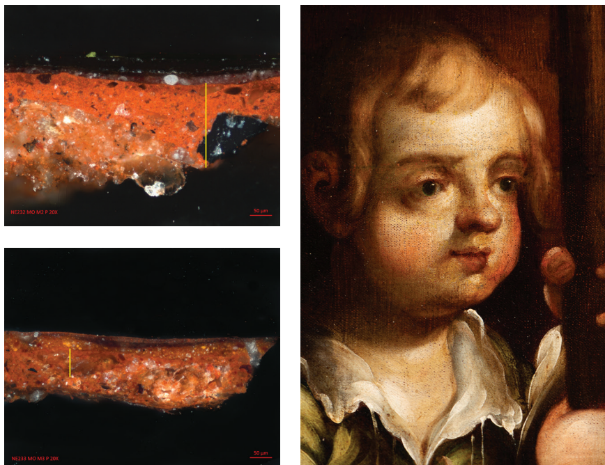
12. En las secciones transversales se indica con líneas amarillas la distribución de las imprimaciones rojas dentro de la estratigrafía de las pinturas. Arriba izquierda, el cuadro de Echave Rioja alcanza 200 micras. Abajo, la imprimación de Villalpando es mucho más delgada con un espesor máximo de 70 micras. Microscopía óptica de polarización, 20x: Elsa Arroyo, 2024. A la derecha, la macrofotografía permite ver que la textura de la tela participa de las sombras y contornos alrededor de la cabeza del niño, Cristóbal de Villalpando, detalle de El Lavatorio .
