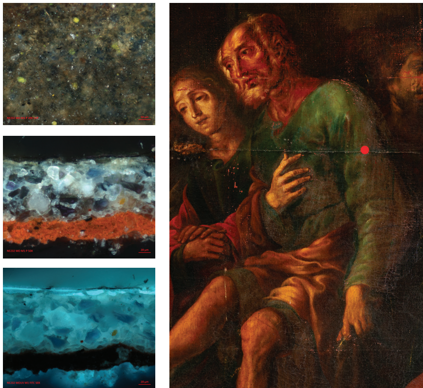
15. En la obra de Baltasar de Echave Rioja los tonos verdes se consiguieron mediante la combinación de esmalte azul de cobalto y una tierra ocre. Arriba, micrografía de la superficie donde se aprecia la distribución de los pigmentos en una matriz oleosa y translúcida. Centro, micrografía de la sección transversal de la muestra color verde extraída de la túnica de san Pedro, polarización, 50x. Abajo, micrografía bajo luz ultravioleta para evidenciar la presencia de los cristales de cobalto en una matriz de albayalde, filtro FITC (519nm). Microscopías: Elsa Arroyo, 2024. Foto: Eumelia Hernández, 2019.
