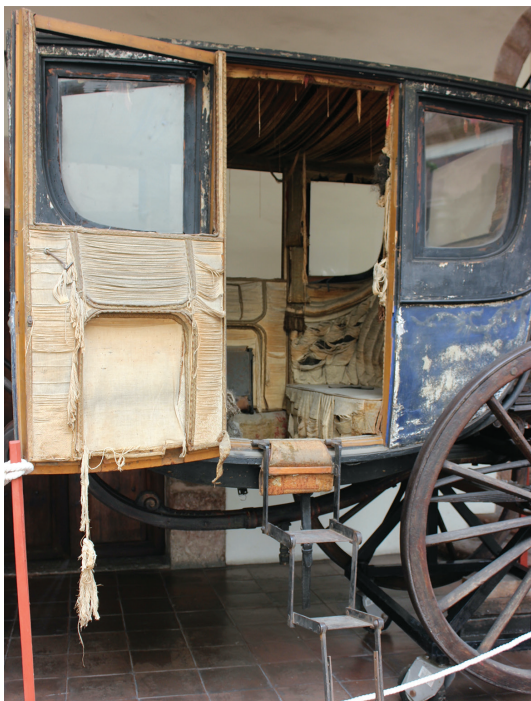
3. Detalle del estribo con mecanismo retráctil, puerta e interior de la estufa. Autor desconocido, estufa eucarística, ca. primer cuarto del siglo XIX. Museo de Sitio Casa de Morelos, Morelia. Foto: Rosalba López López.
